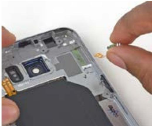
Power button උපාංගය ද පහත අයුරින් ඉවත් කිරීම සිදු කළ හැකි වේ. උල හැඩයට ඇති මෙවලම භාවිතා කර එය ඉවතට ගත හැකි වේ.
