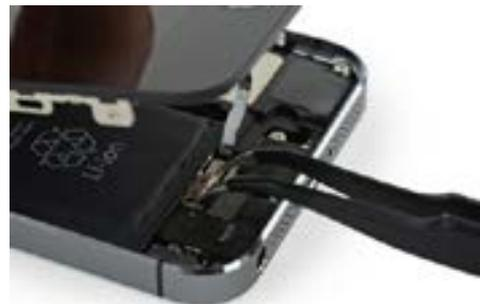
Spudger මෙවලමේ කුඩා යොදා ගනිමින් home button cable connector පහත පරිදි ගලවා ගන්න. මෙහි දී යම් ගම් වර්ග යොදා ඇති බැවින් ඒ පිළිබඳ ඔබ දැනුවත් වී සිටින්න. එසේ එම කේබලය ගලවා ගත් පසු අංශක 90 ක ආනතියක් ඇතිව දුරකථනයේ පිටුපස ආවරණය රූප සටහනට අනුව සිටුවා තබන්න.
