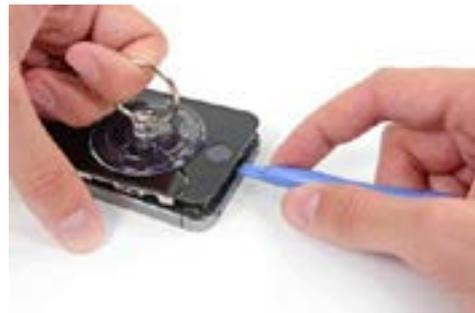
දැන් Suction cup ඉවත් කර ගනිමින් පහත පෙන්වා දී ඇති පරිදි metal bracket covering එක මතුපිට එක් පැත්තකින් spudger හි තුඩ යොදා ගනිමින් එම metal bracket කවරය මදක් බුරුල් කර ගනිමින් එය හා සම්බන්ධ home button cableය ඉවත් කර ගැනීමට උත්සාහ කරන්න.
