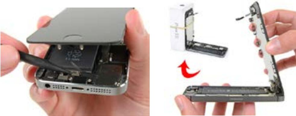
Logic board මත තිබෙන metal battery connector bracketය 1.6 mm Phillips #000 screws වර්ගයේ ඉස්කුරුප්පුවකින් ගලවා ගන්න. Metal battery connectorට අදාළ වන bracket දැන් ගලවා ඉවත් කර ගන්න.
