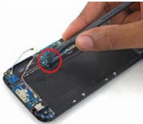
ඉහත ආකාරයට ම motherboard හරහා සවි වී ඇති display assembly cableද disconnect කර ගන්න.
