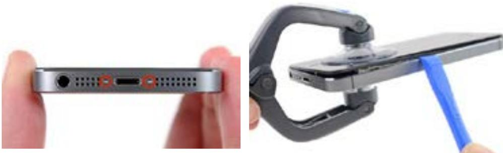
iPhone ජංගම දුරකථනය Power Off කරන්න. ඉන් පසු පහත පරිදි 3.9 mm ප්‍රමාණයේ පංචාස්‍ර හැඩති (Pentalobe) screws ගලවා ඉවත් කර ගන්න. දැන් iSclack මෙවලම යොදා ගනිමින් පහත අයුරින් හැකි තාක් පිටුපස ආවරණය ඉවත් කිරීමට උත්සාහ ගන්න.
