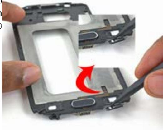
දැන් අවසානයට ලංවී ඇත. රූප සටහනට අනුව Display frame කොටසේ ඇති තවත් soft button වලින් තැනූ LED cableය සහිත plastic frameය රූප සටහනට අනුව ඉවත් කර ගන්න.
