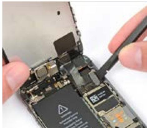
කේබල් ගලවා ඉවත් කිරීම තවදුරටත් සිදු කළ යුතු වේ. LCD cable connector o digitizer cable connector ගලවා දමන්න. මේ අයුරින් ඔබට දුරකථනයේ front panel පිටුපස කවරයෙන් ඉවත් කර ගත හැකි වේ.
