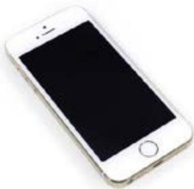
මෙම දුරකථනය ගැන විමසා බැලීමේ දී iOS 10 දක්වා වූ ජංගම මෙහෙයුම් පද්ධති මෙහි ස්ථාපනය කළ හැකි අතර මෙම දුරකථනය නිෂ්පාදනය කර පළමු දින 3 ඇතුළත මිලියන 5 කට අධික දුරකථන ප්‍රමාණයක් විකිණී ඇත. මෙහි ආවරණයද poly-carbonate නම් ප්ලාස්ටික් වර්ගයකින් තනා ඇති අතර 1.3 GHz dual core 32-bit නම් වූ වේගයකින් ක්‍රියාත්මක වන CPU කින්ද 1 GB LPDDR2-1066 RAM ධාරිතාවකින් ද යුක්ත වේ. තවද 16, 32 or 64 GB ආදී ප්‍රමාණ වලින් දත්ත ගබඩා කිරීමට ද හැකියාව තිබේ.
