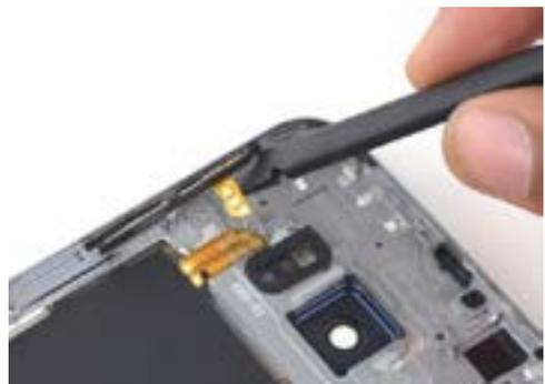
එසේ එය පහත අයුරින් ඉවත් කර ගැනීම සිදු කළ පසු pointed end හිස තිබෙන මෙවලමේ ආධාරයෙන් button covers ය midframe න් ඉවතට ගැනීමට උත්සාහ කරන්න.
