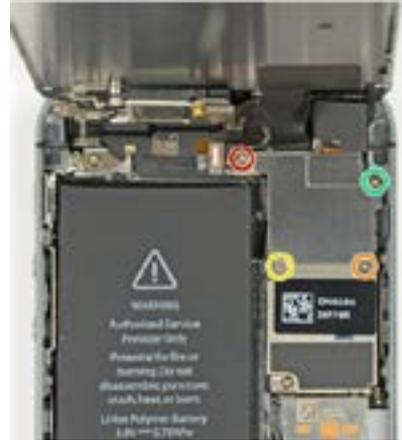
දැන තවදුරටත් panel ය හා සම්බන්ධ වන cable bracket ගලවා ඉවත් කිරීම ආරම්භ කරන්න. Flat tool භාවිතයෙන් front-facing camera සහ sensor cable වෙන් කර ගැනීමට පහත පරිදි උත්සාහ කරන්න.
