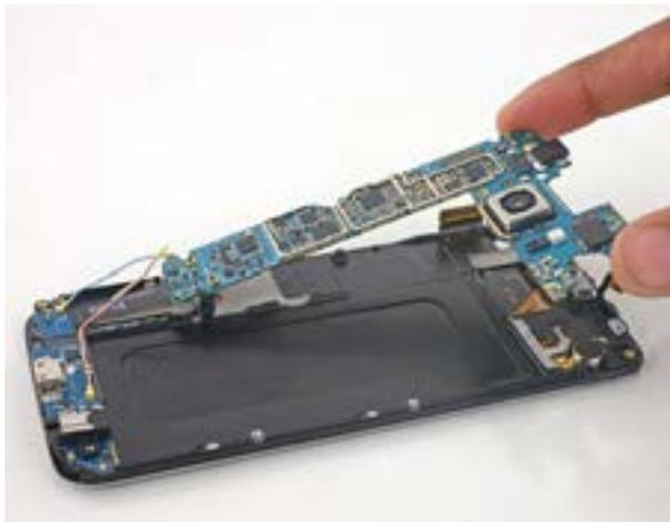
Daughterboard ribbon cable connector පහත අයුරින් motherboard හි යටි පැත්තෙන් සවි වී ඇති socket ගලවා දමන්න.
