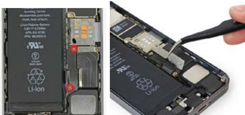
Flat හිස සහිත tool එක භාවිතයෙන් battery connector ට අදාළ වන සොකොට්ටුව ඉතා ප්‍රවේසමින් එයින් වෙන් කර ගන්න. එසේ නැතිනම් එම logic board socketය කැඩී යී හැකි වේ. තවද පහත පෙන්වා දී ඇති අයුරින් screws ගලවා ඉවත් කර ගන්න.
