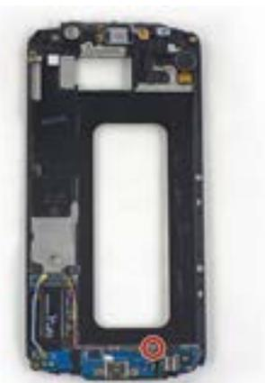
Display frame කොටස අනිත් පැත්ත හරවා එහි ඇති soft button වලින් තැනූ LED cableය රූප සටහනට අනුව ඉවත් කළ යුතු වේ.
